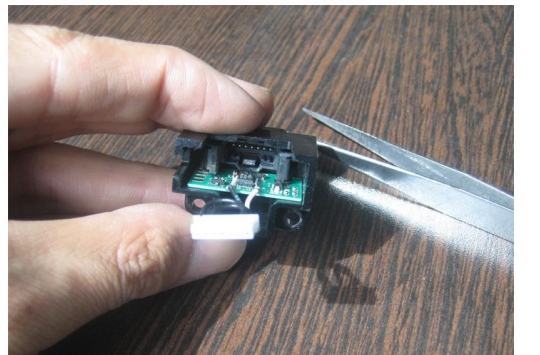
4. 用镊子拨开里面的卡子，取出 IC 插头
